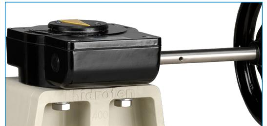
**Hidroten** cuenta en su amplia gama de **válvulas de mariposa** con la **medida de Ø400**, siendo el único fabricante nacional en producirla. Se trata de una válvula realizada en PPR con certificación WRAS, con eje de acero inoxidable A-2 y totalmente mecanizada para ofrecer las máximas garantías de funcionamiento. El cual será siempre suave gracias a su manorreductor y a su sistema de **junta alojada en la mariposa** que aporta un par de maniobra más bajo y estable que otros sistemas.
