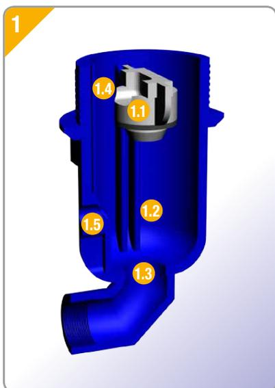
**1.** Debemos introducir siempre la boya pequeña con su junta incorporada (1.1) por la guía del cuerpo (1.2) de forma que comprobemos que llega a bloquear el orificio inferior (1.3), la parte ahuecada de la boya (1.4) mirando hacia la guía del cuerpo (1.5).
