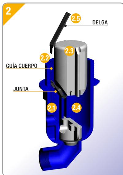
**2.** Introducir la junta (2.1) en la guía del cuerpo (2.2). Introducir la boya (2.3) por las guías del cuerpo (2.4) acompañando la entrada de éste con la entrada de la delga (2.5) por la guía del cuerpo (2.2), evitando que la junta se salga de la guía (2.2).
