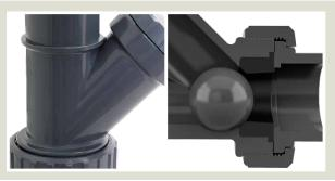
■ La Válvula antirretorno de bola "Ball" es una válvula de retención en "Y" con una bola como único elemento mecánico. Su diseño permite el paso total del fluido, obteniendo bajas pérdidas de carga y siendo apta para su uso con aguas residuales, químicas agresivas y sucias.
